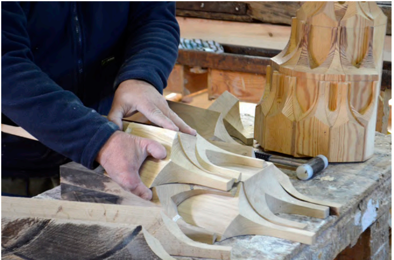
Montaje de mocárabes en el taller de Ramón
