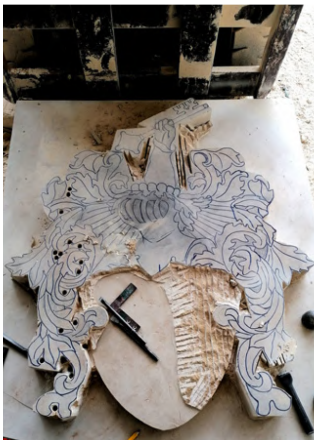
Proceso de ejecución y resultado final de la labra de un escudo de armas en piedra arenisca de Floresta
