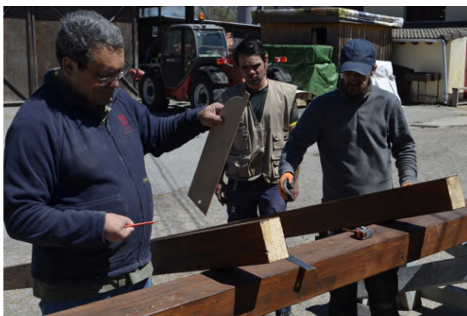
Replanteo del montaje de una estructura en el taller de Ramón
