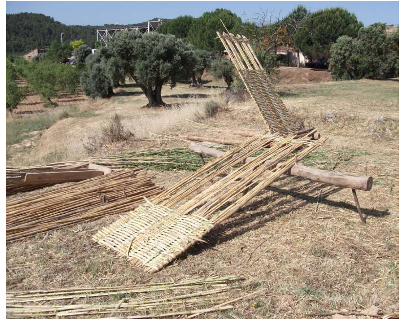
Proceso de producción de entramados de cañas realizados por Javier Pedrola, el Cañicero del Matarraña, Zaragoza
