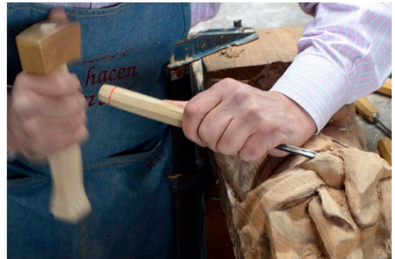
Proceso de talla de una pieza en madera
