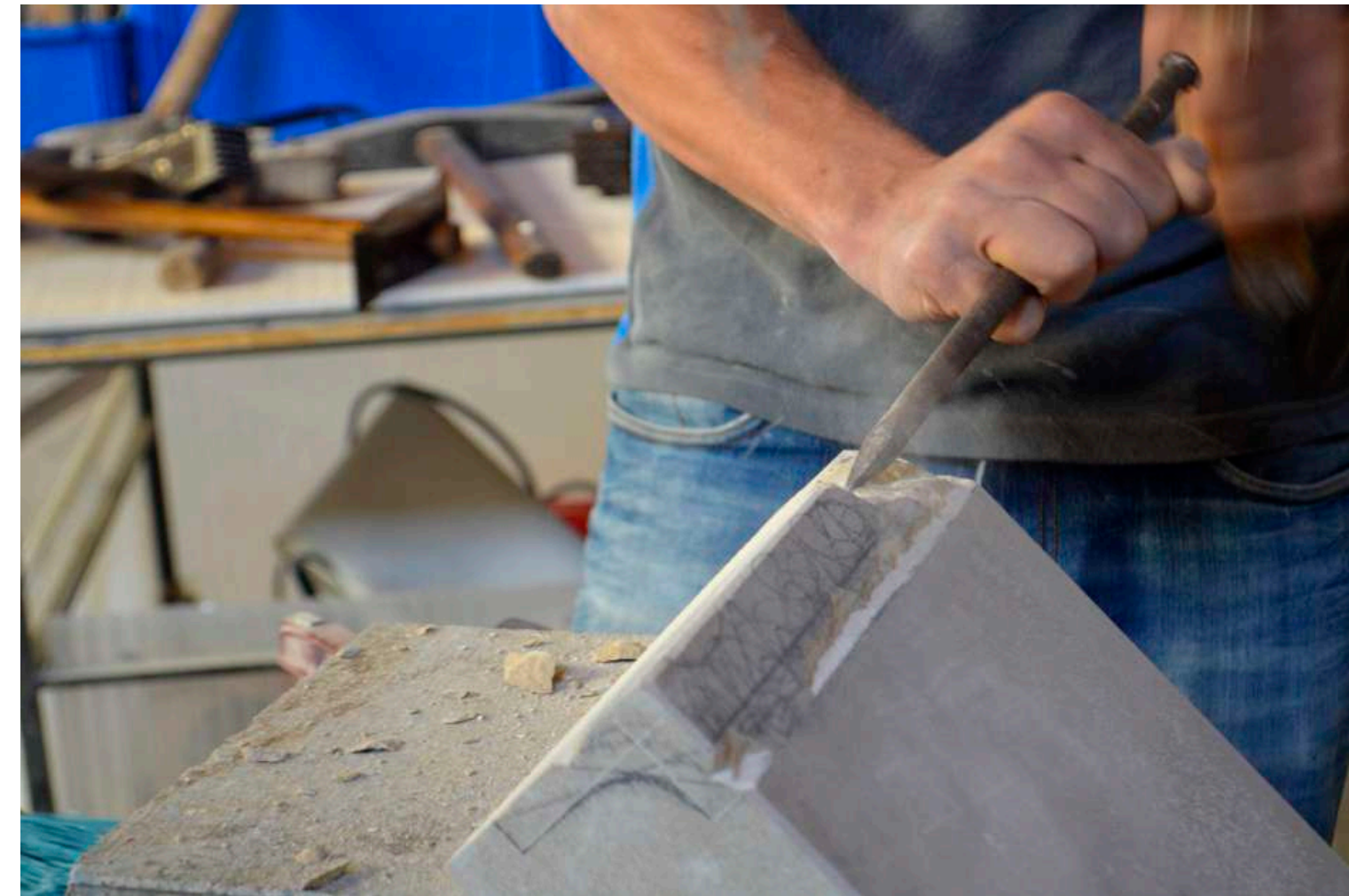
Proceso de desbaste de una pieza con el puntero
