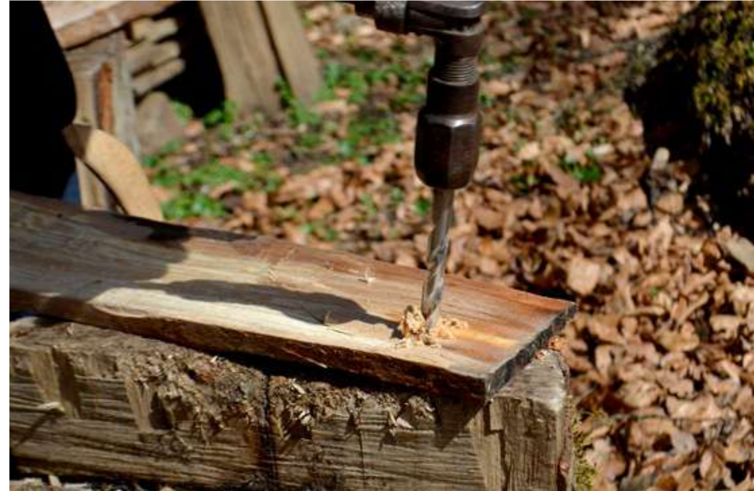
Realización de orificios en las tablillas con la ayuda de un berbiquí para la inserción a presión de las clavijas
