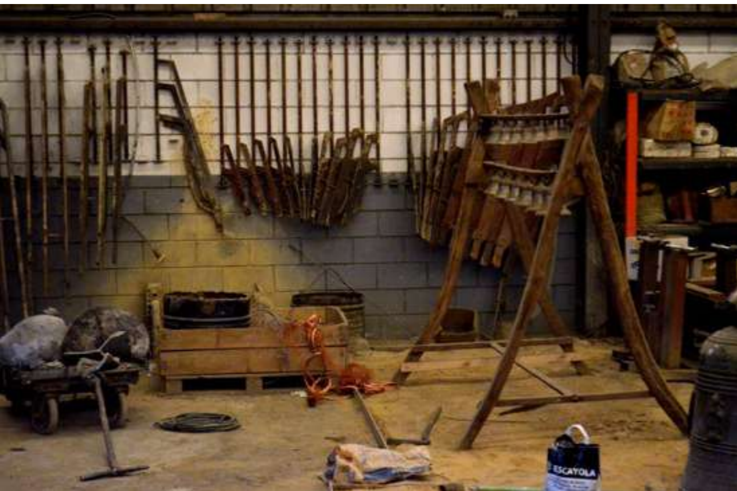
Plantillas para trazar el perfil de las campanas en el taller de Abel Portilla
