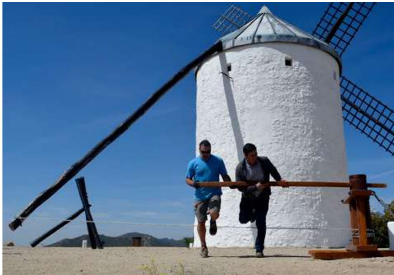
Proceso de orientación del molino mediante el desplazamiento del palo de gobierno
