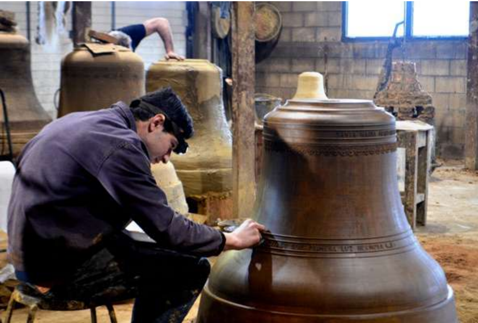
1. Aser Portilla, hijo del maestro Abel Portilla, colocando las letras que formarán parte de los motivos decorativos de una campana
