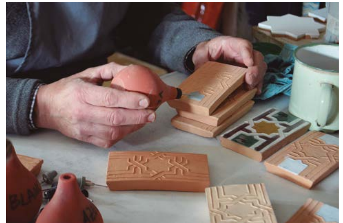
Proceso de elaboración de un azulejo de arista
