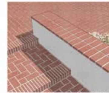
Tappos de ladrillo revestidos con mortero de cal con tappos de ladrillo macizo. Escaleras de ladrillo macizo colocadas a suntuil en el canto del pedáneo y a cresta en el resto
