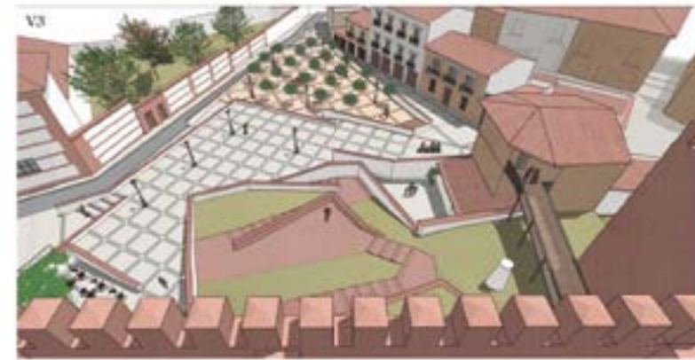
Combinación de los muros de fachada de las cuevas con cornisa de ladrillo en pisco de gresillo y teja árabe
