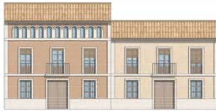
Fachada principal 1:100 Casa a dos mans - Anchura de fachada 7,0m - profundidad 7,0m con dos crujías
