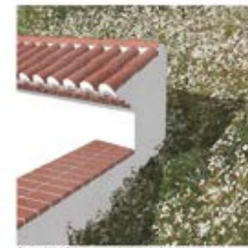
Combinación de los muros de fachada de las cuevas con cornisa de ladrillo en pisco de gresillo y teja árabe
