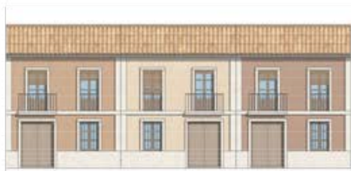
Fachada principal 1:100 Casa a una má - Anchura de fachada 5,7m - profundidad del cuerpo principal 7,0m con dos crujías
