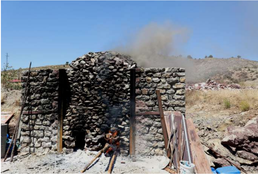
Horno para la cocción de yeso artesanal de Albarracín Forno para cozer gesso artesanal Albarracín Kiln to cook traditional gypsum plaster of Albarracín
